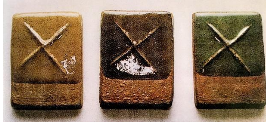
Görsel 1. Aynı seladon sırnın yükseltgen, nötr ve indirgen ortamda pişirilmiş örnekleri, 1260°C.
