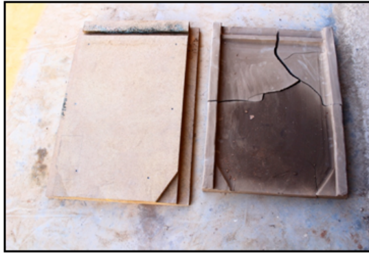
Şekil 8. Kalıp Yöntemi ile Korint Tipi Kiremit Yapımı
