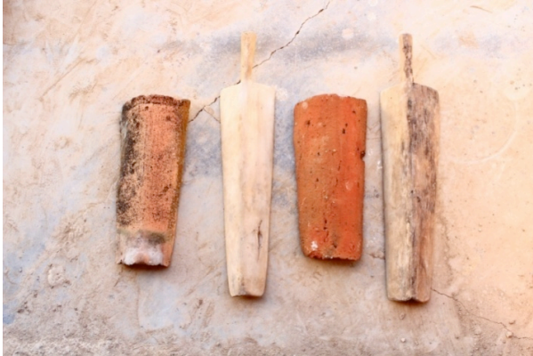
Şekil 4. Kapama kiremit üretiminde kullanılan kalıplar
